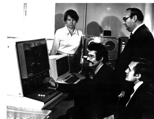
УПДМЛ - установка подготовки данных на магнитной ленте
